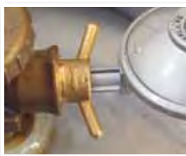
T.v. Gasolbehållare med monterad reducerventil
